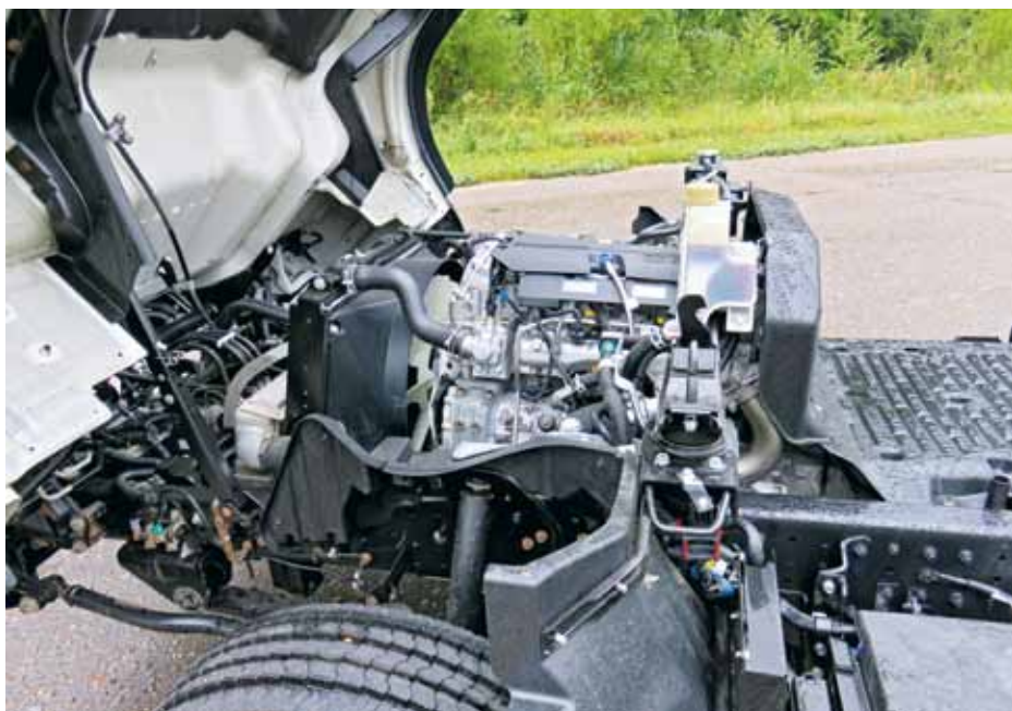
Моторный отсек и внешняя характеристика 175-сильного двигателя
